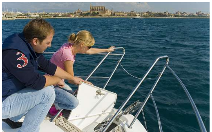
Tatsächlich, der Anker hält. Bei einer Tiefe von fünf Metern habe ich 15 Meter Kette gegeben - mehr geht übrigens nicht
