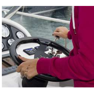
Rechte Maschine vor, linke zurück und schon dreht sich die Bavaria auf der Stelle
